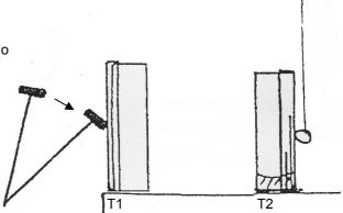
Posizionare su un tavolo i due tamburelli T1 e T2 a una distanza di ca. 10 cm l'uno dall'altro (cfr. disegno) con la membrana rivolta verso l'esterno. La pallina di polistirolo tocca la membrana di T2. Colpendo la membrana di T1, la pallina si allontana dalla membrana di T2.
