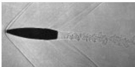
Abb. 1: Schlierenaufnahme eines mit Überschallgeschwindigkeit fliegenden Gewehrgeschosses. Deutlich sind Kopf- und Schwanzwelle erkennbar. (Foto: EMPA)
